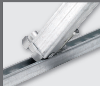
Leichte Befestigung durch Einsetzen in C-Schienen mit dem Maß: 27 x 18 mm und der Profillöpfung von 15 mm
