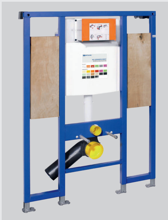
Wand-WC-Trockenbauelement für barrierefreies Bauen, inkl. 2 Schichtholzplatten zur Aufnahme von Stütz- und Haltegriffen, Bauhöhe 1120 mm, inkl. Wandhalter
