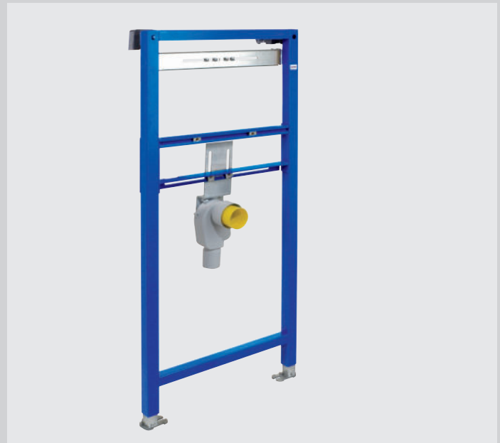
Waschtisch-Trockenbauelement für Wandarmatur, mit UP-Geruchverschluss für barrierefreies Bauen, Bauhöhe 1120 mm, inkl. Wandhalter – Montageplatte zur Aufnahme der Wasseranschlüsse Art.-Nr. 30 470 03 112 000
