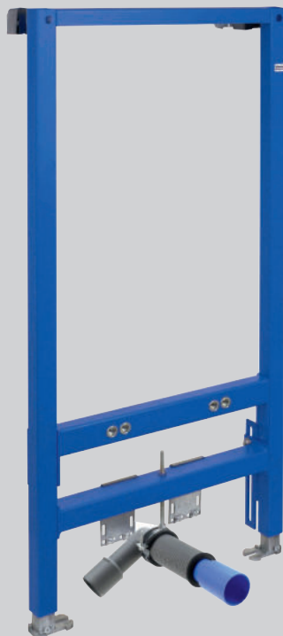
Wand-Bidet Trockenbauelement für Einlocharmatur, Bauhöhe 1120 mm, inkl. Wandhalter Art.-Nr. 30 470 00 112 000
